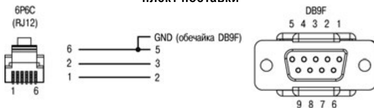
Рисунок В.2 – Схема кабеля программирования KC2
