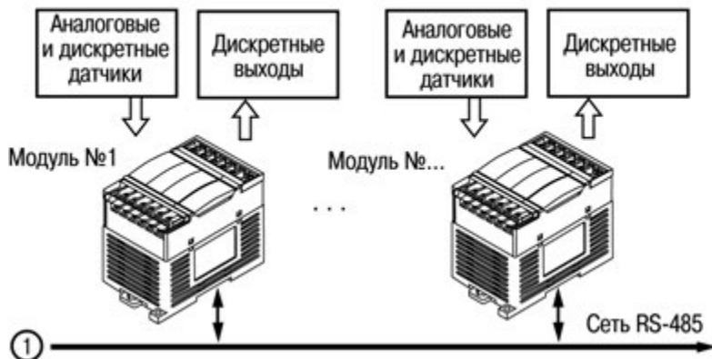
Рисунок 6.4 – Пример структуры соединений при использовании ПЛК в системе
