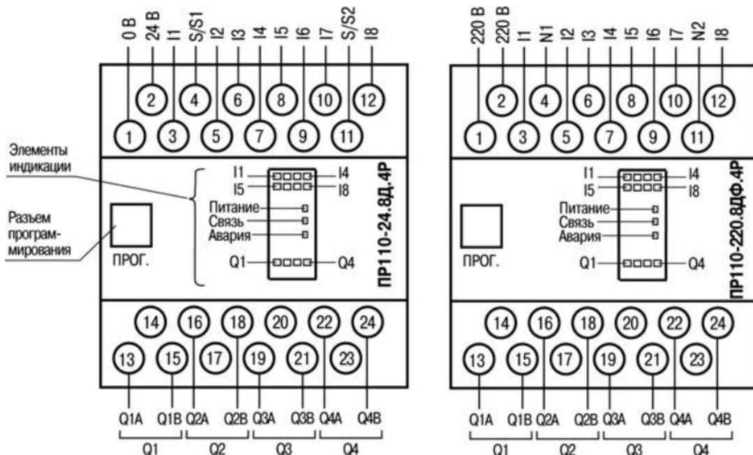
Рисунок Б.1 – Расположение контактов и элементов индикации в приборах PR110-x.8x.4x
