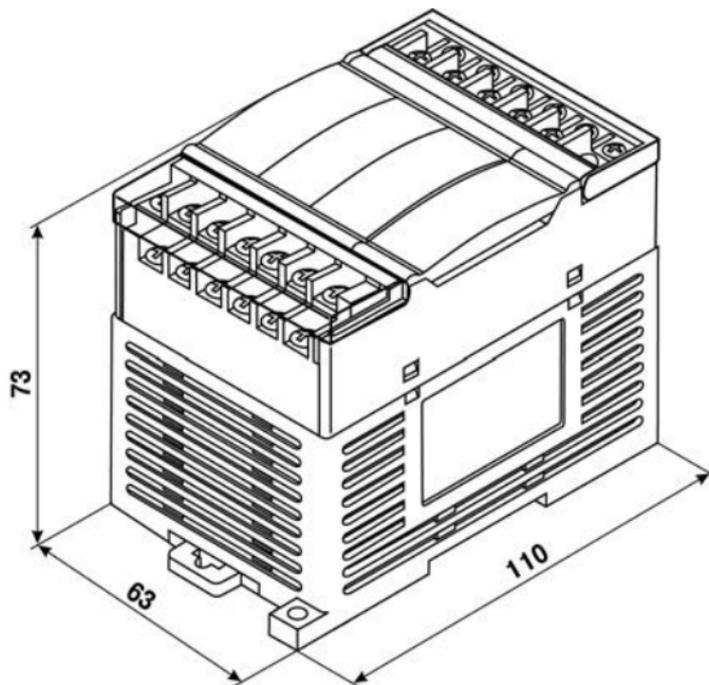
Рисунок А.1 – Габаритный чертеж ПР110-х.8х.4х
