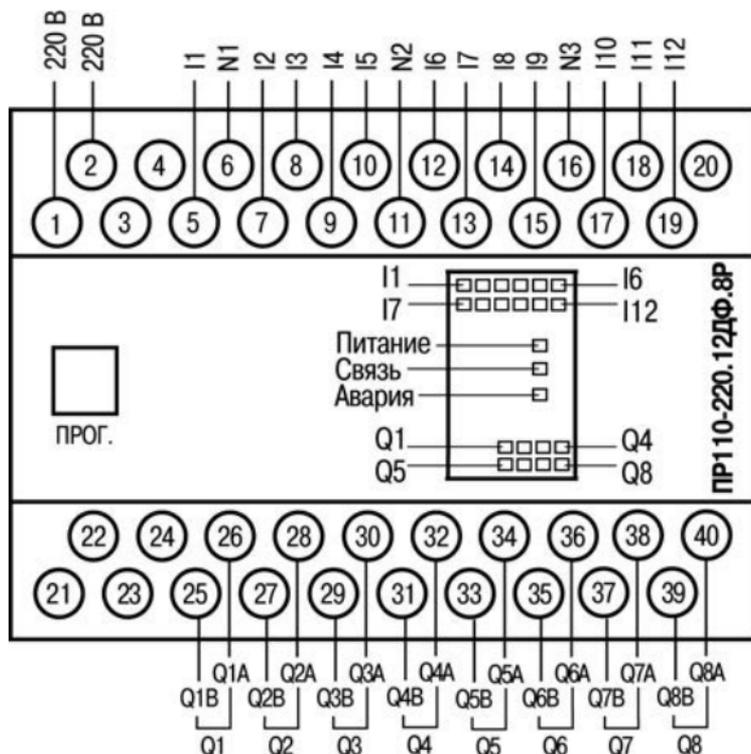
Рисунок Б.3 – Расположение контактов и элементов индикации в приборах
