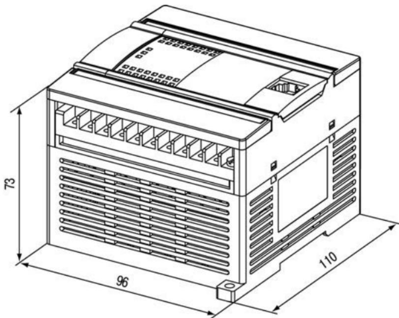
**Рисунок А.2 – Габаритный чертеж ПР110-х.12х.8х**
