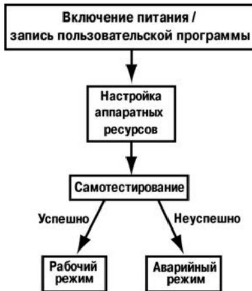
Рисунок 3.1 – Алгоритм запуска прибора
