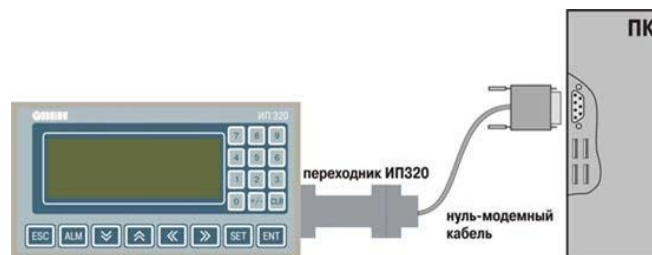
Рисунок 5.1 – Схема подключения интерфейса RS-232 для конфигурирования панели ИП320
