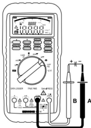
Bild 8: Durchgangsprüfung mit Summer
