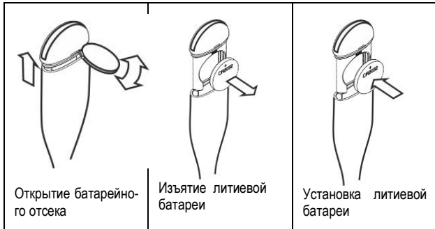
Рисунок 2 – Установка и изъятие литиевой батареи
