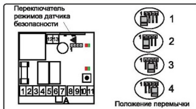
Рисунок 9. Положение переключки при переключении режимов датчика безопасности
