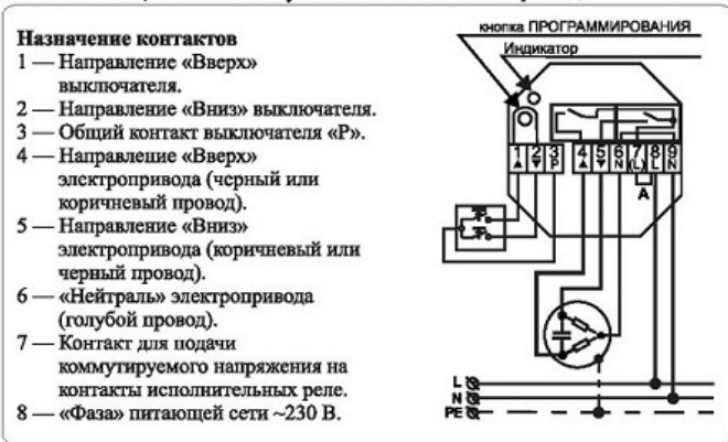
Рисунок 1. Типовая схема подключения Radio 8113 UP
